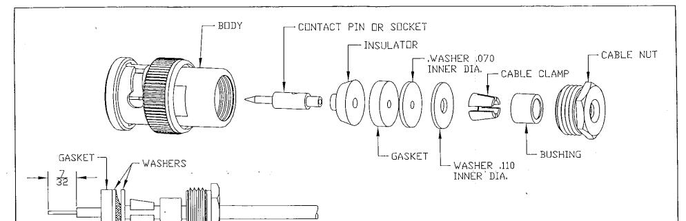
2. COMB OUT BRAID, TRIM INNER DIELECTRIC TO DIMENSION AND TIN THE CENTER CONDUCTOR. FOLD BACK BRAID AND TRIM FLUSH WITH WASHER, SLIDE SECONDED WASHER TIGHT AGAINST THE BRAID AND SLIDE GASKET ONTO DIELECTRIC OF CABLE AS SHOWN.
